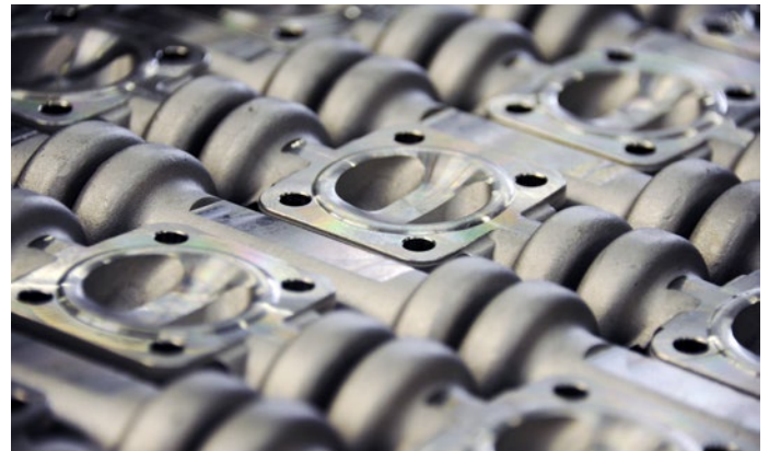
Angearbeitete Ventilkörper (D-Körper) auf dem Weg zur weiteren Bearbeitung
