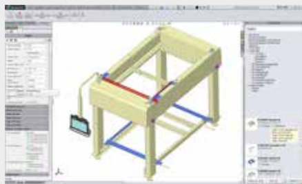
Die Anlagenmodule bestehen aus einem Grundgestell, das sich im Aufbau immer wieder ähnelt.
